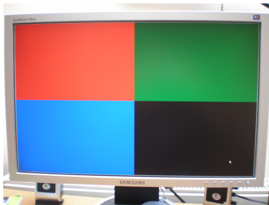
Obr. 22. Farby monitora pre určenie jeho otočenia v obraze z kamery
