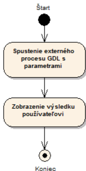
Obr. 7.8: Diagram činností funkcie kontrolujúcej syntax VHDL súboru
