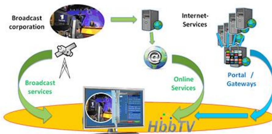
Obr. 2.3: Prepojenie HbbTv s vysielacími službami [2]
