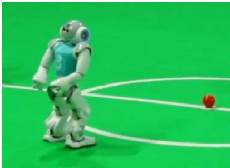
Obrázok 9 - Pozícia rúk robota pri chôdzi
