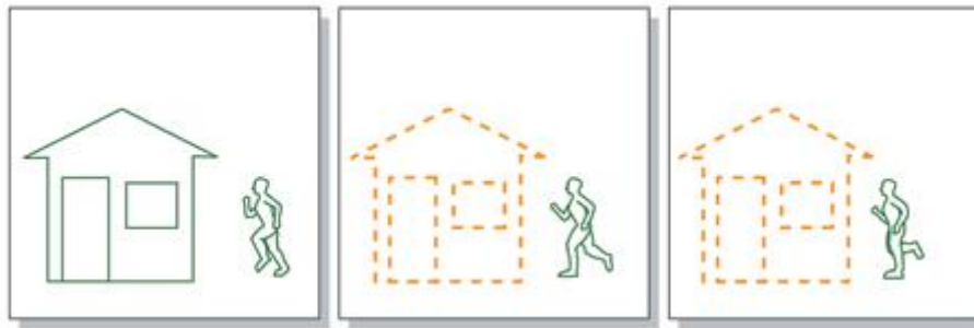
Obrázok 2: princíp kódovania MPEG-4 a H.264 [3]
