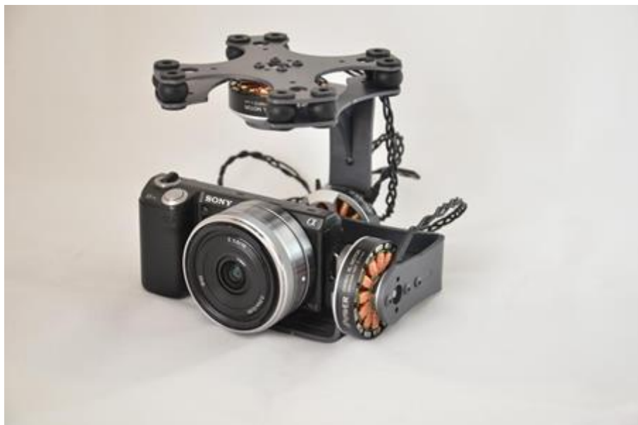
Obrázok 25: Príklad existujúceho riešenia konštrukcie na otáčanie kamier 8
