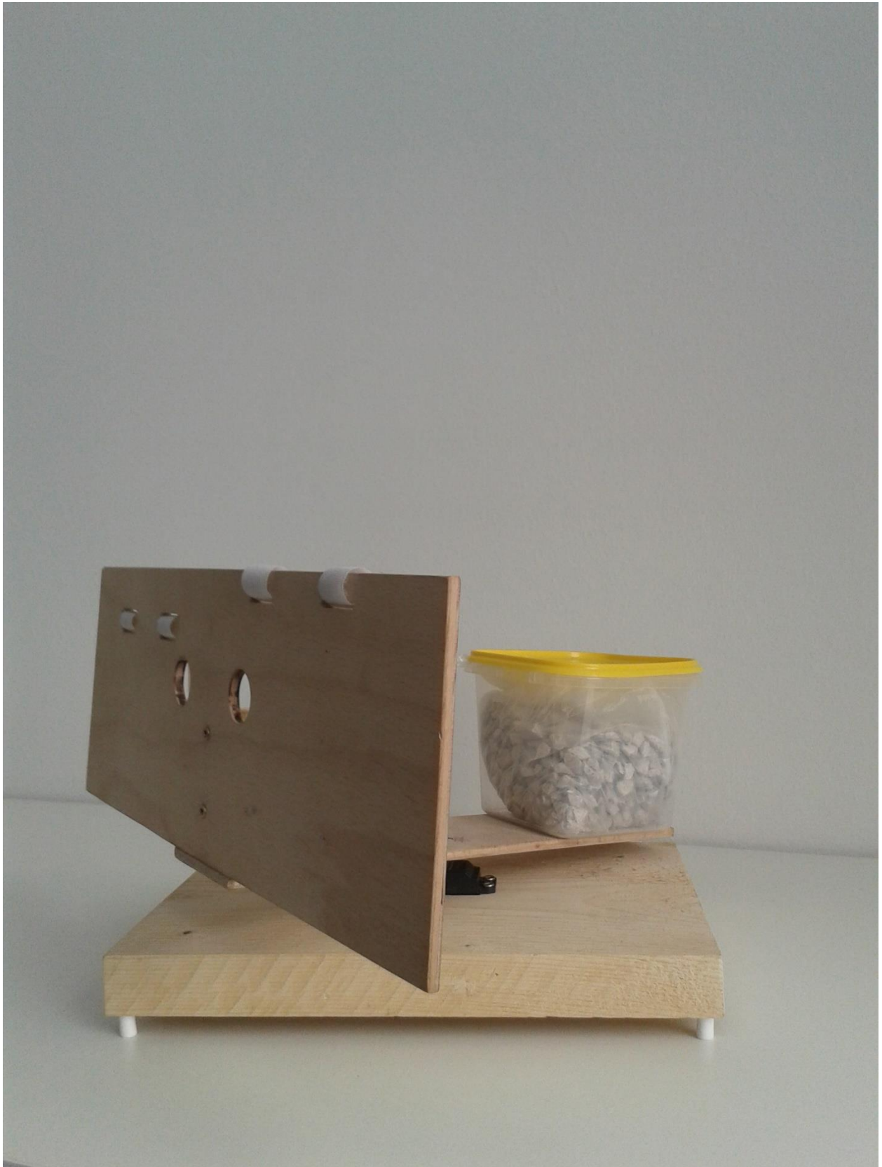
Obr.č.1: Prototyp otáčania kamier v jednej osi.
