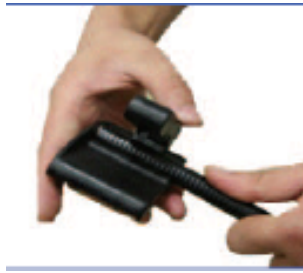
Obr. B.3: Prerezanie izolácie
