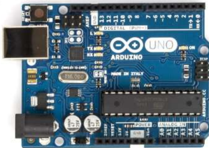
Obrázok 3.3 Mikrokontrolér Arduino Uno [8]
