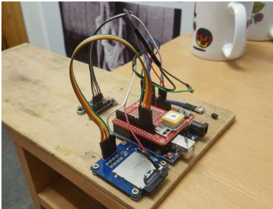
Obrázok 3.17 Prvý prototyp na platforme Arduino UNO
